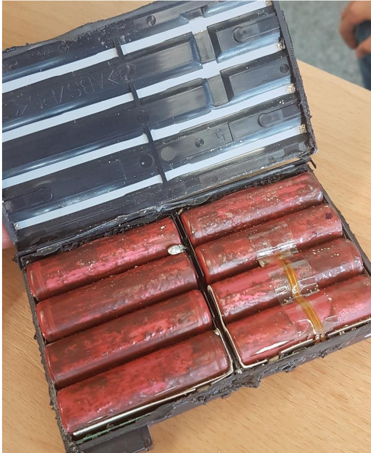
Abbildung 8: Laptopakkumulator mit gebrauchten Li-Ion-Akkuzellen des Typs 18650 (Eigene Fotografie vom 8.8.2017)
