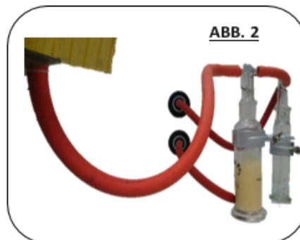
HINWEIS: Damit die Waschflaschen ihre Funktion übernehmen, müssen Sie richtig montiert werden. Eine Waschflasche besteht aus einem Eingang und einem Ausgang. In diesem Fall hat der Eingang ein langes Glasrohr, welches nach unten zum Boden ragt. Diese Seite muss mit der Zelle verbunden werden. Um die zwei Waschflaschen zu verbinden, wird das Ende der ersten Waschflasche mit dem Anfang der zweiten Waschflasche verbunden. Das Ende der zweiten Waschflasche wird an die Vakuumpumpe angehängt.
