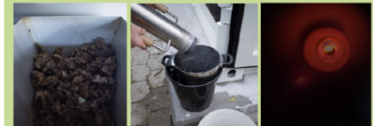
Abb. 1 Während der Pyrolyse der Fäzes: getrocknete Fäzes im Feder (links), frische FK zur Abkühlung im Wassereimer (mitte), Erstick in der Brennkammer durch das Zulufröhr (rechts)
