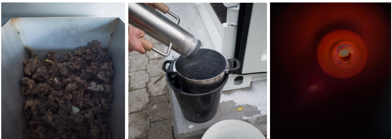
Abbildung 8 Während der Pyrolyse der Fäzes: getrocknete Fäzes im Feeder (links), frische FK zur Abkühlung im Wassereimer (mitte), Einblick in die Brennkammer durch das Zuluftrohr (rechts)
