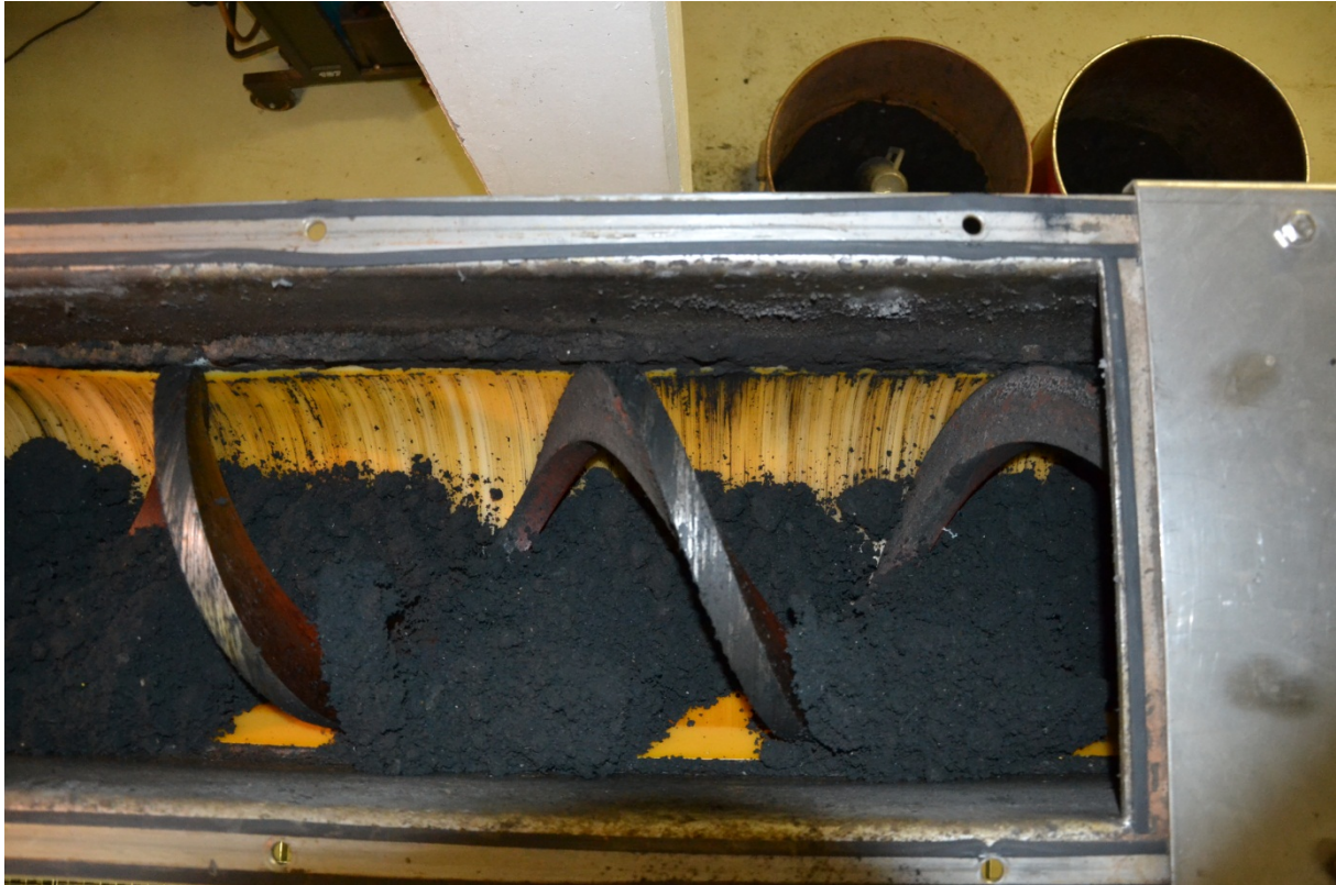
Abbildung 42: Förderschnecke für den Transport von Klärschlamm (zusammen mit HTC-Kohle) in den Ofen der SVA Winterthur (Kläusli, 2013)
