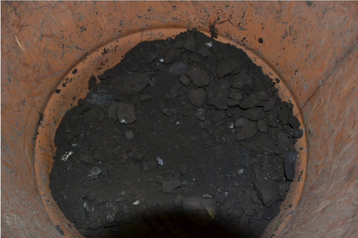
Abbildung 40: Struktur der bei der SVA Winterthur verwendeten HTC-Kohle (Kläusli, 2013)
