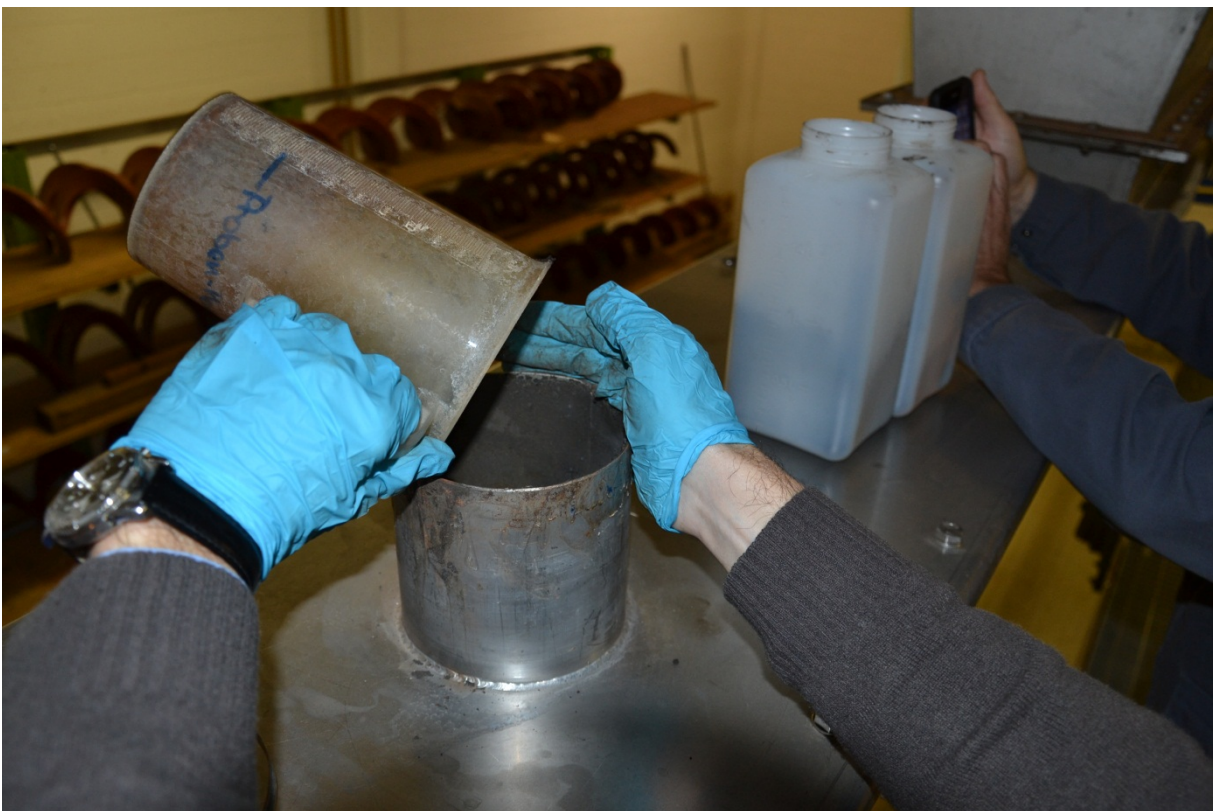
Abbildung 41: Manuelle HTC-Kohlezudosierung bei der SVA Winterthur (Kläusli, 2013)
