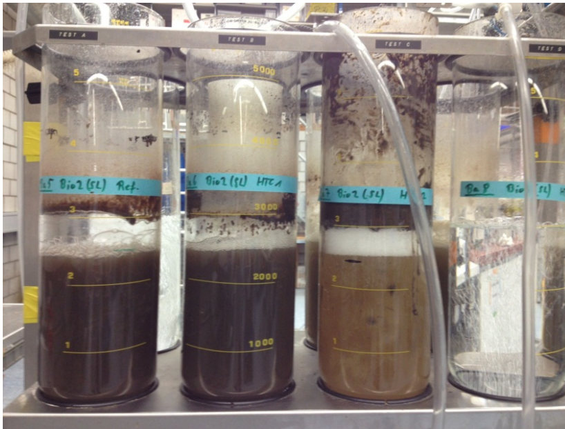
Abbildung 8.: Gläser 5 bis 8 der Schwachlaststufe (simulieren ARA Oftringen Bio 2) während des zweiten Experiment-Durchgangs.
