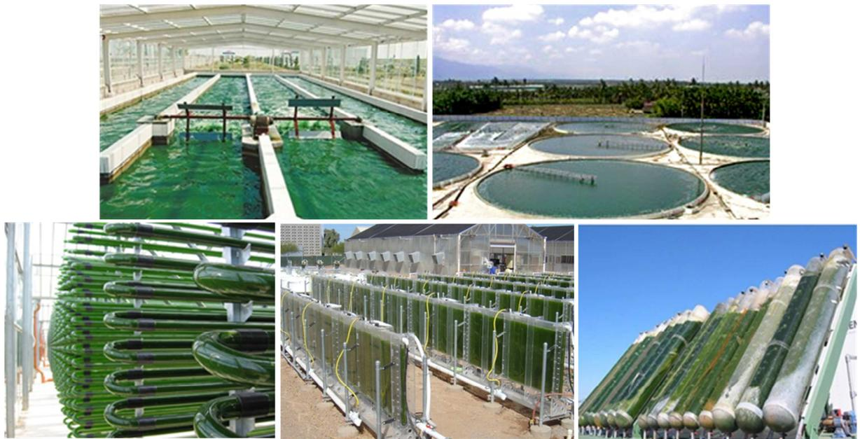
**Figure 3.** Systèmes de production de micro-algues type bassin, PBR tubulaire, PBR plat et PBR colonne sous serre ou à l'extérieur.
