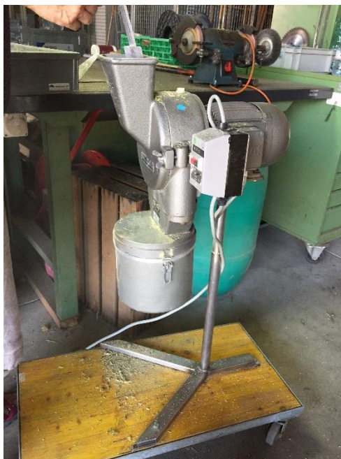
Abbildung 19: Erste Zerkleinerung der trockenen Proben in der Schlagrotormühle (eigenes Bild, 2018)
