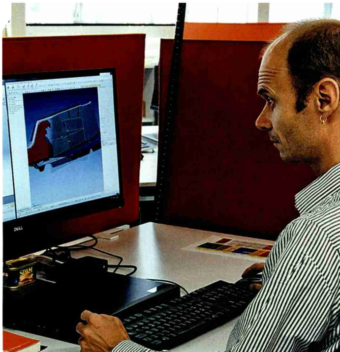
Auch gescannte Objekte müssen am PC nachbearbeitet werden, um ein korrektes 3D-Modell zu erstellen.
