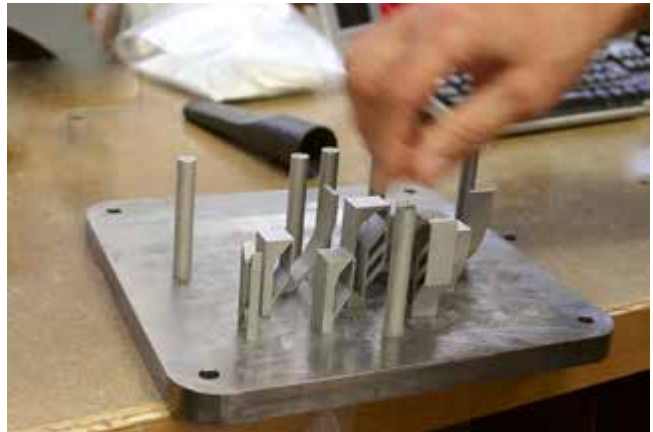
Am Anfang steht immer der Quader und der Zugstab – Stichwort: Festigkeit, Oberflächenrauigkeit, Neigungswinkel, Porosität, etc.
