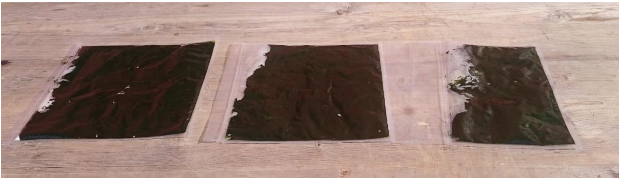
Abbildung 6: Die Algenpaste wurde als Vorbereitung für die Gefrier Trocknung in Vakuumbuteln dünn ausgestrichen und gefroren.
