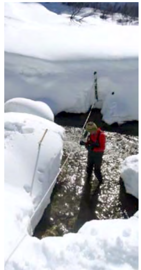
Abbildung 7: Impression aus der Messkampagne zur Bestimmung der Wassertiefen in Abhängigkeit vom Abfluss.
