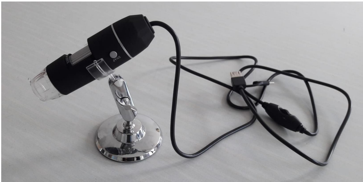
Abbildung 22: "Digital Microscope" mit USB und Micro USB Anschluss. Mit einem Handy und dem portablen Mikroskop können auf dem Feld gute Aufnahmen gemacht werden. Das Mikroskop wurde bei Pius Fleischmann, Pflanzenschutzmittelberater der Firma Omya (Schweiz) AG Agro gekauft.
