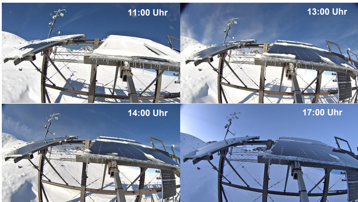
Abbildung 29: Tagesbeispiel für die Schneebedeckung der Segmente A und B zum Vergleich mit Abbildung 28 (01. Dezember 2018). Segment A links, Segment B rechts.
