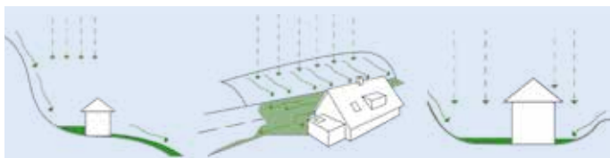
Abb. 1: Typische Gefährdungsbilder bei Oberflächenabfluss sind der Zufluss vom Hang (links), von angrenzenden Strassen, Vorplätzen und Zufahrten (Mitte) sowie die Ansammlung von Wasser in Mulden (rechts). Quelle: VKG.
