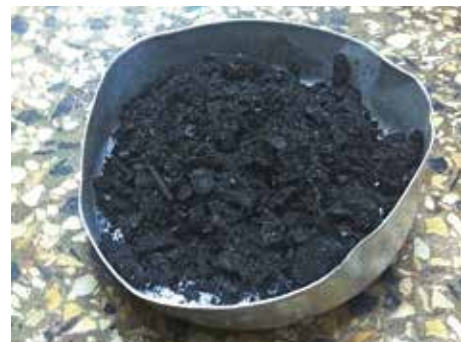
Abb. 3: Durch Pyrolyse produzierte Kohle aus Fäkalschlamm
