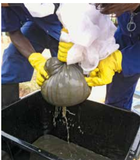
Abb. 2: Sammeln und Entwässern des Fäkalschlammes auf der Anlage
