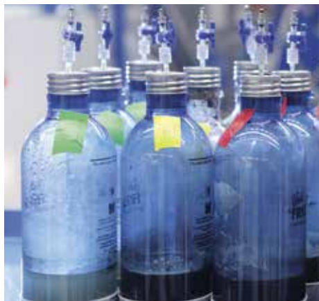
Abb. 1: Bestimmung des Biomethanpotentials (BMP) im Labor: Gärversuche nach VDI 4630 als Batchtest.
