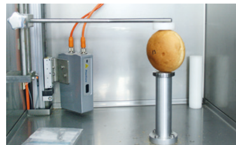
Abb. 3: Laserbasierter Scanner zur Volumen- und Dimensionsmessung der Buns
