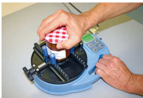
Abb. 2: Öffnungskraftmessung von Verpackungen mit Drehverschluss
