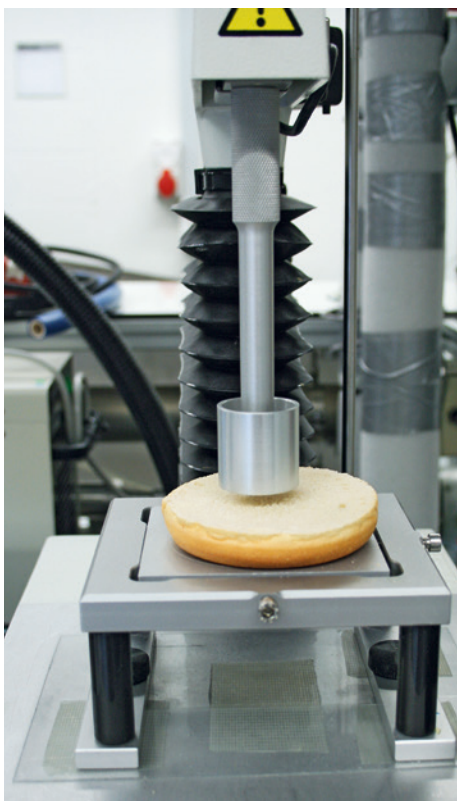
Abb. 2: Texture-Analyser zur Messung der Krumen-Festigkeit
