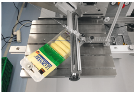
Abb. 1: Öffnungskraftmessung von peelbaren Verpackungen
