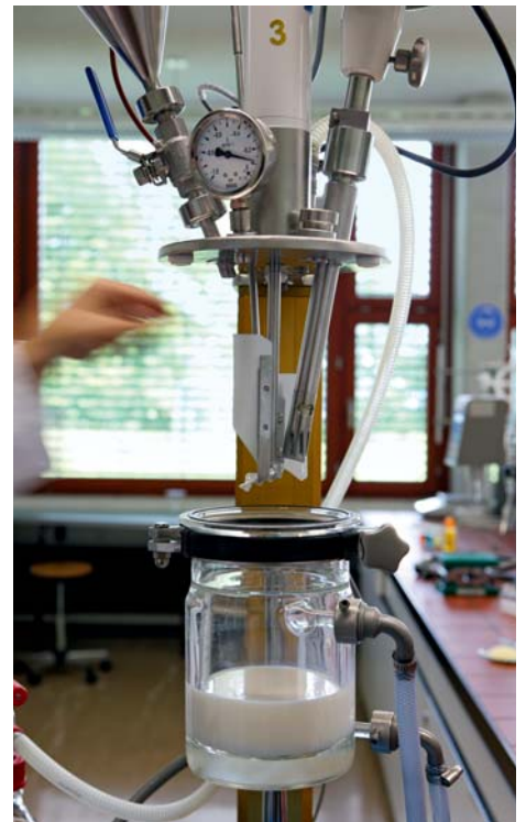
Entwicklung einer O/W-Emulsion mittels Escomischer ZHAW.
