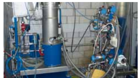
20-Liter-Labor-Membranbioreaktor der Fachgruppe Umweltbiotechnologie an der ZHAW.
