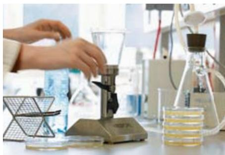
Wasser wird durch eine Membran filtriert
