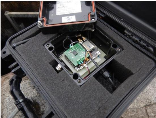
**Abbildung 3: Sensor-knoten, Prototyp. Sichtbar sind: Antenne, Kabelanschluss, Board mit Microcontroller und Funkmodul.**
