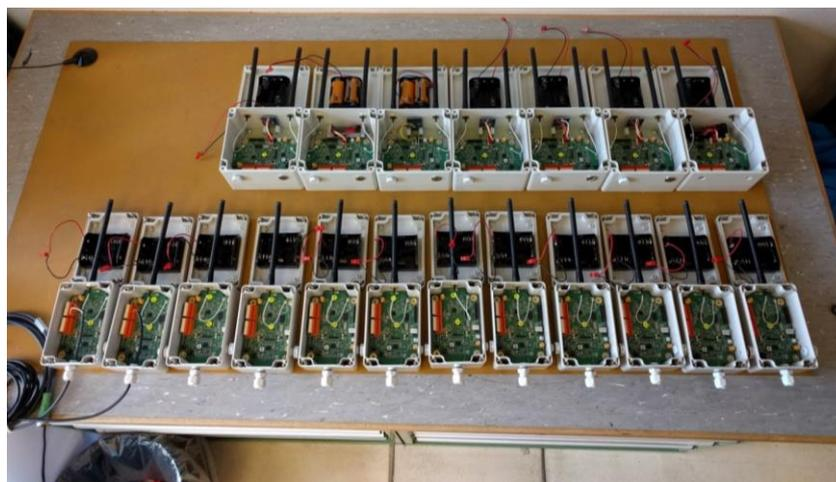
Abbildung 9: Sensor- und Repeaterknoten (oben) während der Prototypen-Fertigung an der Eawag.
