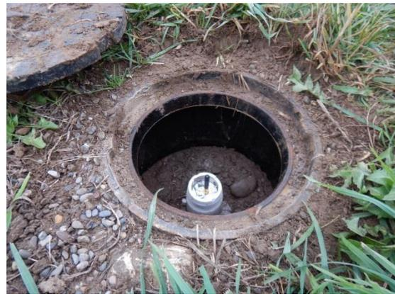
**Abbildung 4: Piezometermessstelle, CTD-Sonde mit LoRaWAN-Funkmodul (Fremdproduktion).**
