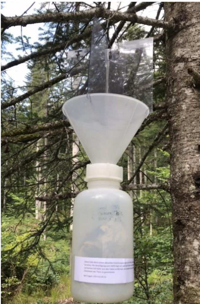
Abbildung 1 Aufbau der zum Nachweis des Zottenbocks verwendeten Pheromonfalle.
