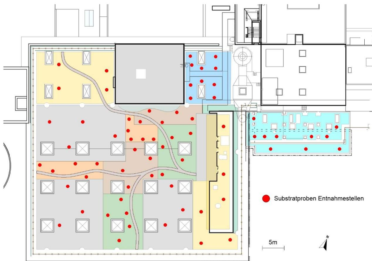
Abbildung 7: Entnahmestellen Substratproben (Quelle: Brunner 2018, verändert durch Autor)
