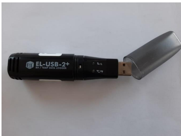
Abbildung 18: Verwendeter Datenlogger EL-USB-2+ der Firma Lascar.
