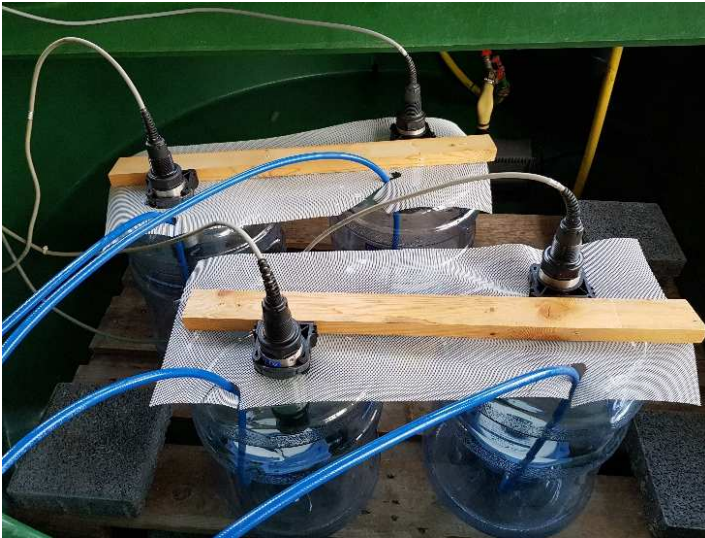
Abbildung 2: Rundstrombecken mit Arbeitsplattform und den darauf platzierten Wassergallonen. Die Gallonen sind mit Keramikausströmer, LDO-Sonden und einer Abdeckung ausgestattet.
