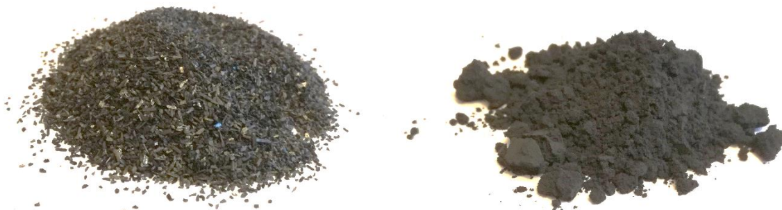
Abbildung 4: Beim Filtrationsversuch wurden grössere Kohlepartikel (125 – 200, links) verwendet als in den restlichen Versuchen (<250 \mu m, rechts). (eigene Aufnahmen)
