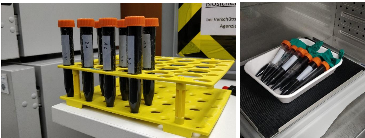
Abbildung 2: Die in der Zellsuspension gelöste Pflanzenkohle (links) wurde für die restlichen Versuche horizontal (rechts) auf dem Schüttler platziert. (eigene Aufnahmen)
