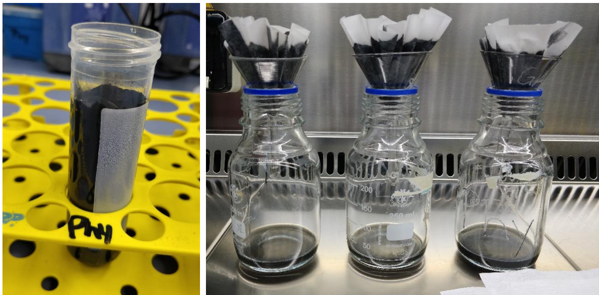
Abbildung 3: Für die Oxidation der Pflanzenkohle wurde diese zuerst 2 Stunden in einer 10%-H 2 O 2 -Lösung eingelegt (links) und anschliessend abfiltriert (rechts). (eigene Aufnahmen)
