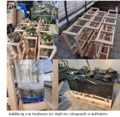
Abbildung 3: A: Proben der Töpfe im Folientunnel, B: Auffanggefäss montiertes Gefäss für die Sickerwasser. C: Filterschicht mit Trenngitter aus PE. D: Fertiger Aufbau mit befeuchteten Töpfen.
