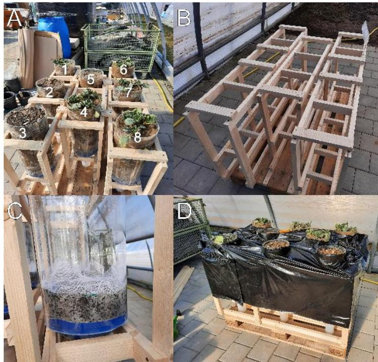
Abbildung 2: A: Positionen der Töpfe im Haltegestell; B: Auf Palette montiertes Gestell für die 50 cm tiefen Töpfe; C: Filterschicht mit Trenngewebe aus PE; D: Fertiger Aufbau mit bepflanzt Töpfen.
