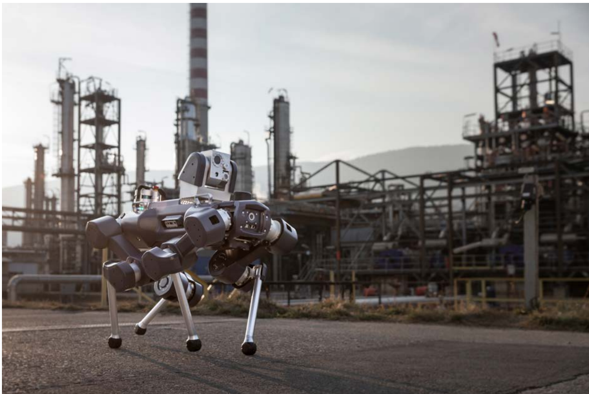
Abbildung 10: ANYmal X der erste Laufroboter der Welt, der in ATEX Zonen darf; Quelle: (ANYbotics, 2022)
