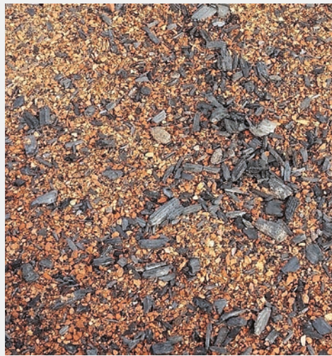
Fig. 3 Nicht überbaubare Pflanzsubstrate mit Ziegelschrot und roher Pflanzenkohle (links) und mineralisches Substrat mit kompostierter Pflanzenkohle (rechts; INKoh soil ). (©Burkhardt, Saluz)
