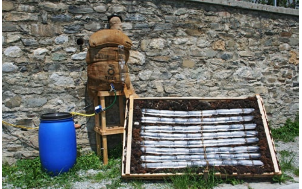
Versuchsaufbau Sonnenkollektor in Wergenstein (Bild: Christen und Hösl)
