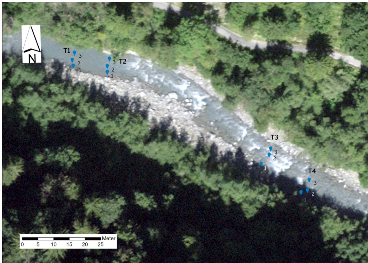
Abbildung 2: Exemplarische Darstellung einer Untersuchungsstelle mit vier Transekten (T1 bis T4) sowie den pro Transekt erhobenen drei Probenahmepunkte (1: Ufernah, 2: Mitte, 3: tiefste / schnellste Stelle). Fliessrichtung von rechts nach links. Hintergrundkarte: ©Swisstopo, 2019.
