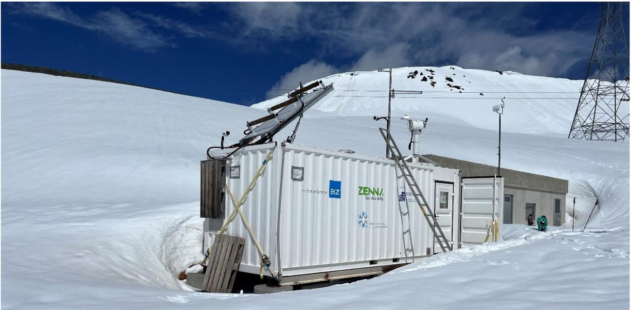
Abbildung 4. Detailansicht der installierten Mini-PVA auf dem Dach des Messcontainers. Da der Container nicht perfekt gegen Süden ausgerichtet ist, wurde die Mini-PVA um ca. 13° verdreht fixiert.
