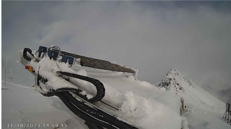
Abbildung 10. Charakteristische Hochnebel/Wolken-Wettersituation mit zeitlich und räumlich sehr stark fluktuierenden Einstrahlungsbedingungen, aufgenommen am 31. Oktober 2023, 14.59 Uhr. Im Vordergrund sichtbar die (verschneite) Mini-PVA, unten rechts im Bild ein Teil der grossen, stationären Versuchsanlage.
