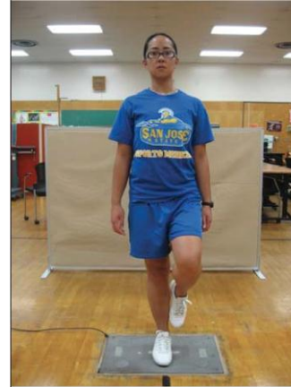
Abbildung 2. EBST auf Kraftmessplatte.
