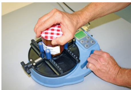
Abb. 2: Öffnungskraftmessung von Verpackungen mit Drehverschluss
