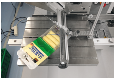
Abb. 1: Öffnungskraftmessung von peelbaren Verpackungen
