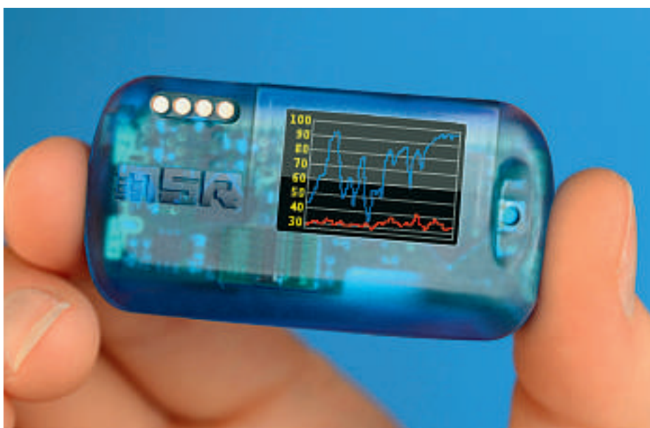
Der Funk-Datenlogger MSR 145 WD erfasst und speichert den Verlauf von Feuchtigkeit, Temperatur, Druck, Beschleunigung, Licht und weiteren Parametern
