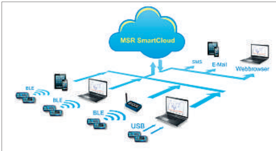
Es gibt verschiedene Verbindungsoptionen, um die aufgezeichneten Daten des Loggers auszulesen
