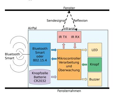
Der kleine Sensor AirPal optimiert die Lüftungszeit durch die Überwachung des Fensterzustandes
