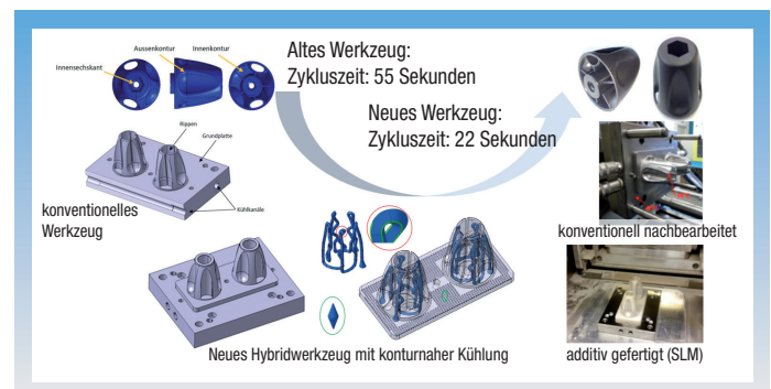
Bild 6: Additive Fertigung eines Hybrid-Spritzgusswerkzeugs (1.2709), Mehrwert: Reduktion Zykluszeit Hybridwerkzeug mit konturnaher Kühlung.
