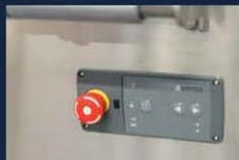
Kontroll-Panél für Antrieb mit Not-Aus-Schalter Panneau de contrôle de l'entraînement avec interrupteur d'arrêt d'urgence
